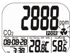
Abb. 5: Anzeige bei Alarm
